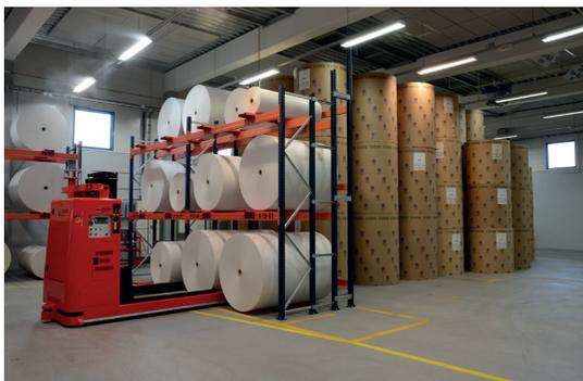
Solving offre una vasta gamma di sistemi di movimentazione automatica nell'industria cartaria: AGV, Mover a cuscino d'aria, sistemi a ruote e sistemi su binari. I sistemi di movimentazione possono essere usati per movimentare non solo bobine di carta ma anche pallet di fogli, tamburi e anime.
