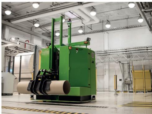
Solving offre una vasta gamma di sistemi di movimentazione automatica nell'industria cartaria: AGV, Mover a cuscino d'aria, sistemi a ruote e sistemi su binari. I sistemi di movimentazione possono essere usati per movimentare non solo bobine di carta ma anche pallet di fogli, tamburi e anime.
